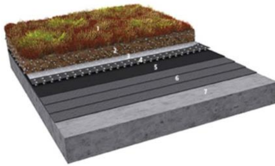
Kuva 6.2. Viherkaton rakenteet. Kuva: Leca Finland Oy.
