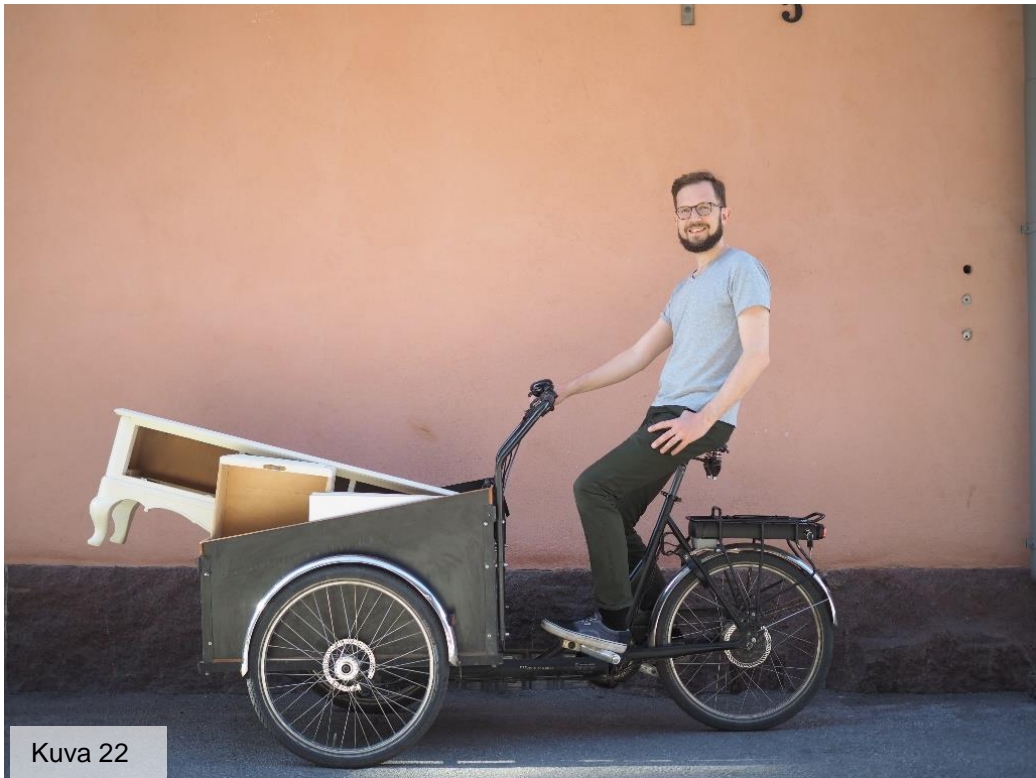
Kuva 22: Sähköavusteinen, kolmipyöräinen tavarapyörä (kuva: Martti Tulenheimo)
