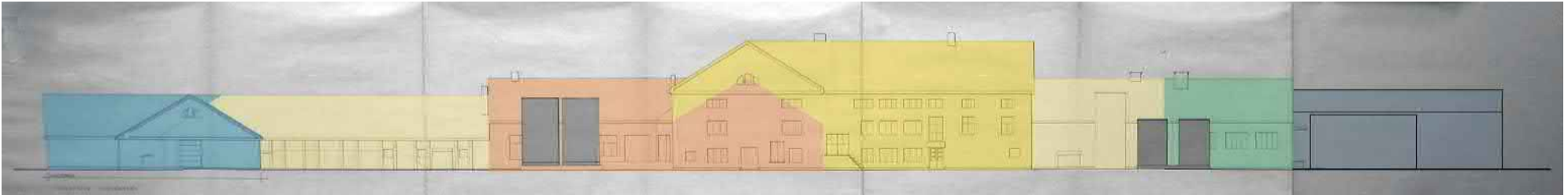
Kuva 17. Rakentamisen vaiheistuskaavio, julkisivu luoteeseen (Taustalla Arkkitehtitoimisto O. Ylipahkalan piirustus 1982, Limingan Osuusmeijerin arkisto)
